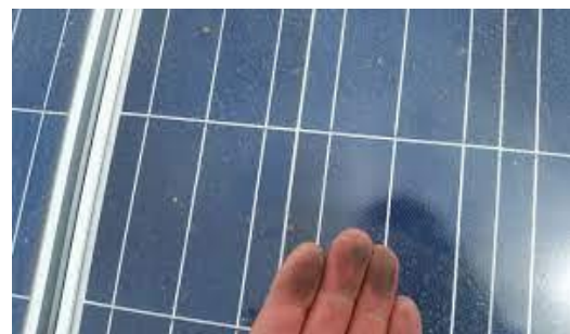
Gambar. Hot spot pada modul PV (kiri); Kotoran/debu pada modul PV
